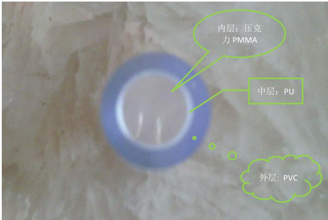
内层： 材料为压克力，直径5~30mm
